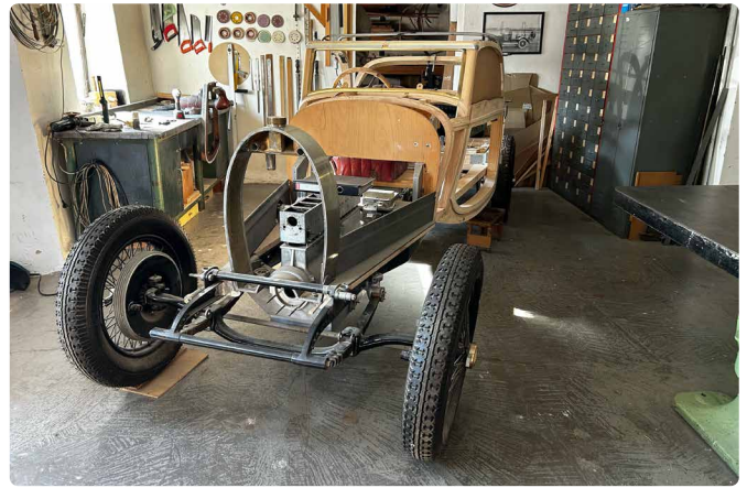
Auto mívala dřevěné konstrukce, proto je nedílnou součástí dílny i truhlárna.
